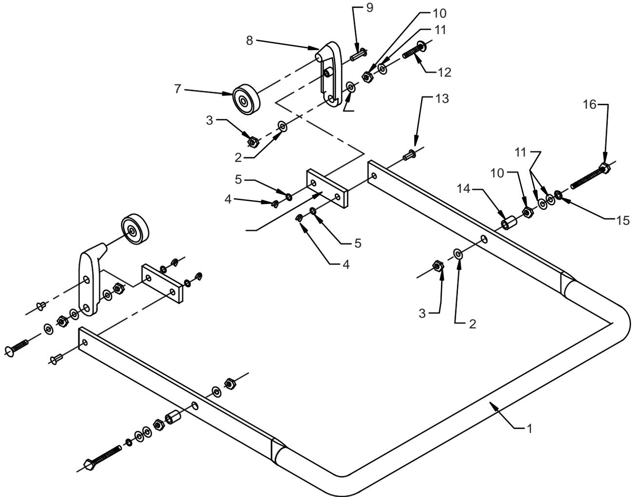
**PARTS LISTING - ILLUSTRATION #6 : DUST PAN LEVER ASSEMBLY**
