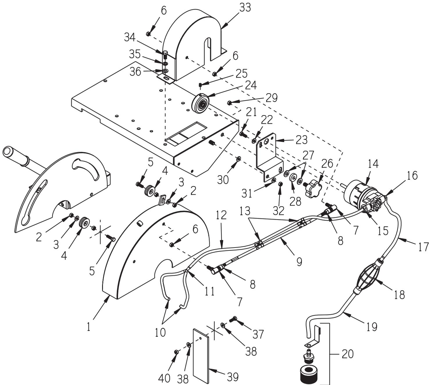
**PARTS LISTING - ILLUSTRATION 4 : WATER PUMP & BLADE GUARD GROUPING**
